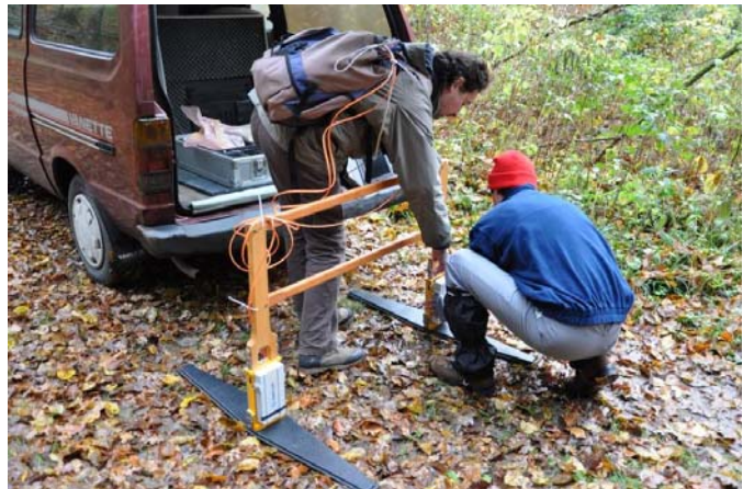
Montage d'un radar terrestre (enregistrements très difficiles à exploiter)
