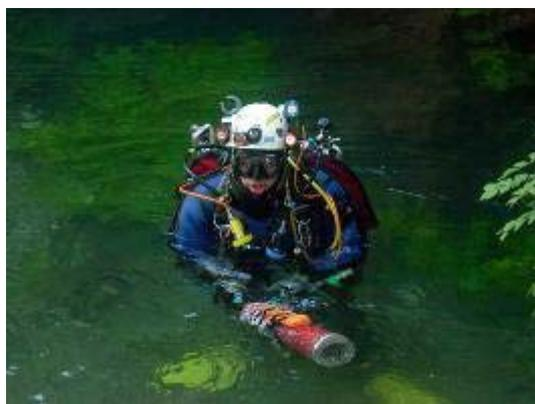
Avant de descendre installer la cloche, je montre au groupe présent ce jour là, le fonctionnement du "perfo" et la façon de l'utiliser dans l'eau ainsi que le montage de la cloche. Le "perfo" sera alimenté en air par une bouteille de plongée, munie d'un 1<sup>er</sup> étage.
